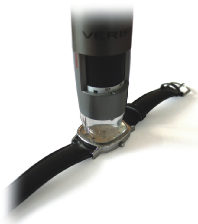
下图：通过一个USB接口的显微镜(随处都可以买到)，将照相信息传输到计算机数据库中存档或比较，用来检验盘面上印刷痕迹的细微差别。
